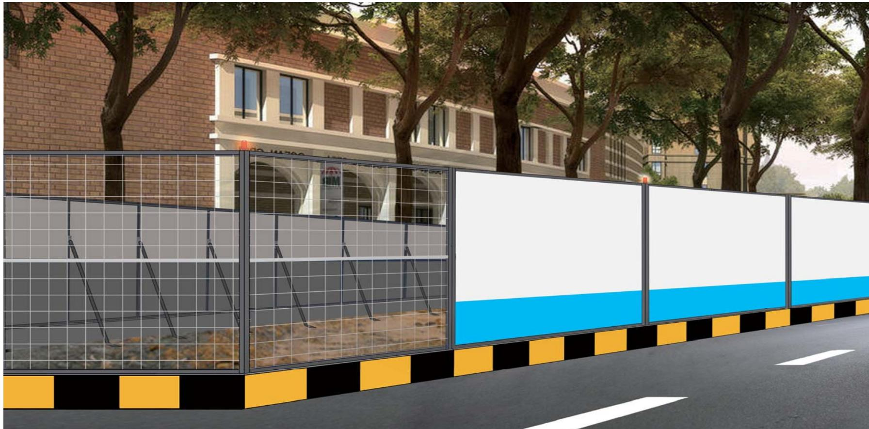
**基本要求：**围挡高度为230cm、厚度6cm,底座高度30cm,厚度30cm；围挡材料为挤塑板、0.3mm厚以上彩钢板，支撑架采用5cm×5cm镀锌角钢。围挡基座采用砖砌、混凝土预制块、现浇混凝土等形式。当采用预制混凝土块基座时，应对基面采取混凝土浇筑或水泥砂浆铺筑等方式进行找平处理，安装完成后在围挡区域内侧砌防溢墙。防溢墙宽度20cm以上，高度30cm以上。色彩以浅灰色、湖蓝色和中黄色为基调。
